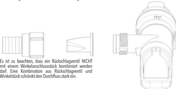
Es ist zu beachten, dass ein Rückschlagventil NICHT mit einem Winkelanschlussstück kombiniert werden darf. Eine Kombination aus Rückschlagventil und Winkelstück schränkt den Durchfluss stark ein.
